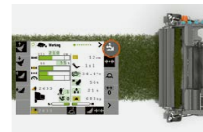
L'alimentazione a comando idraulico del PFS può essere impostata comodamente dal sedile del trattore.
